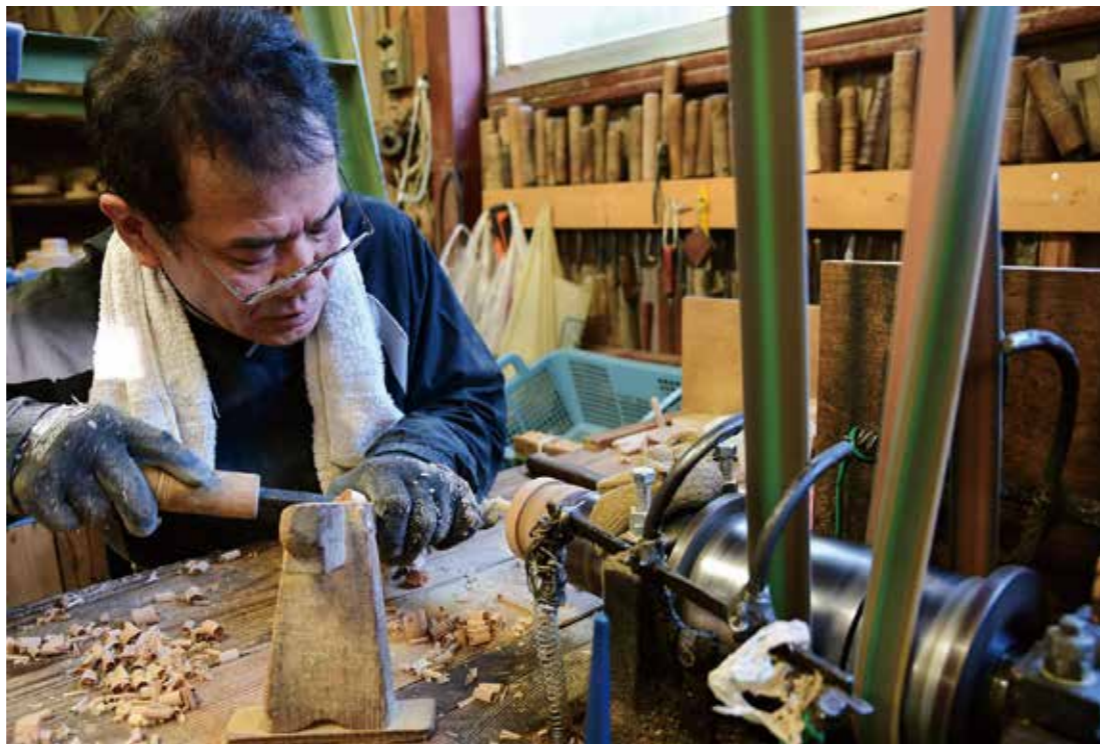
年代物の機械ろくろに木材を固定させ、歯を当ててコマを削り出していく。
